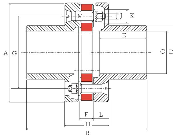
Montaje de las referencias 635105, 635106, 635107 : tornillo cabeza fresada
