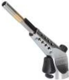
• Metaljet y forma Ultramapp gas junto al sistema de antorcha más potente y eficiente en el mercado • Una combinación de tecnología de combustión moderna y única mezcla de gas le da una temperatura de llama de 2400 ° C • El mango de metal resistente con acero inoxidable de alta quemador de ciclón eficientes para 8707 calentamiento instantáneo alrededor de la tubería • Calefacción obras, soldadura y soldadura se hará con mayor eficiencia la calidad.
